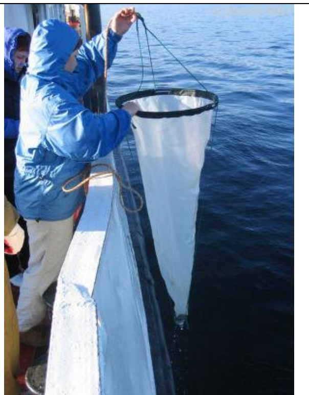
Рис. 2. Малая сеть Апштейна (длина образующей конуса 55 см, диаметр входного отверстия 25 см, диаметр стаканчика 3,5-4 см) и возможная конструкция стаканчика к ней (а — стаканчик из банки с крышкой, б — металлический стаканчик с краном)
